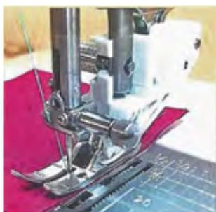
Wenn die Stoffkante an der rechten Füßchenkante entlang läuft, dann können Sie eine 1/4 „ breite Naht nähen!
