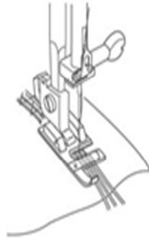
Der Kordelnähfuß H, nimmt 1 - 3 Kordeln die Kordeln gehalten und genau in die Naht geführt. Unterschiedliche Nutz und Zierstiche können zum Aufnähen gewählt werden. Die Auswahl der Kordel, des Nähfadens und des Stiches sind die entscheidenden Faktoren für die endgültigen Effekte der Naht.
