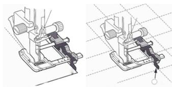
Durch die stufenlose Einstellung ist jede Nahtbreite möglich. Den Hebel an der Rückseite der Führung heben oder senken, um die Führungsschiene zu bewegen oder zu sichern. Die Kante oder eine Naht an der Führung ausrichten und spielend einfach Säume und parallele Nähte nähen.
