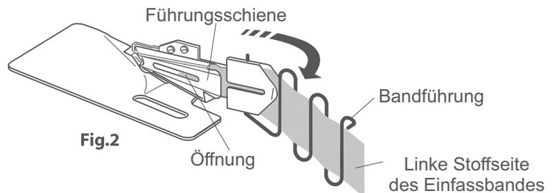
Ziehen Sie ca. 5 cm des Einfassbandes aus der Mündung der Schiene heraus und legen Sie das Einfassband im rechten Winkel nach hinten.
