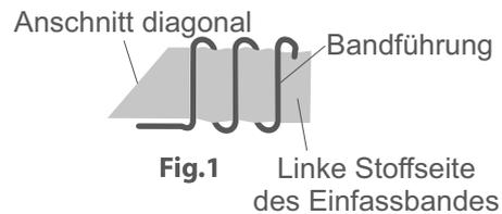
Führen Sie das Einfassband mit der linken Stoffseite nach vorne und rechts nach links durch die Bandführung, wie in Abb. 2 gezeigt. Führen Sie das Einfassband in die Führungsschiene ein und schieben Sie es mit einer Pinzette in Richtung der Schienenöffnung.
