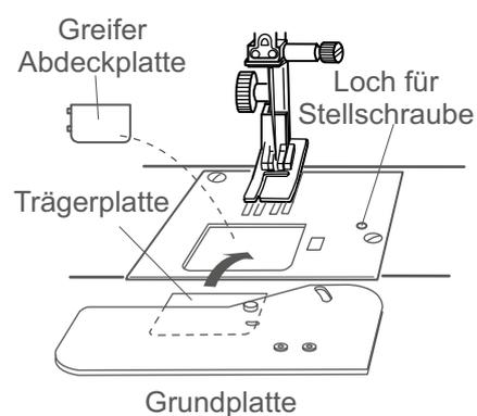
Drehen Sie die Stellschraube (B) ein und ziehen Sie diese mit einem Schraubendreher fest.
