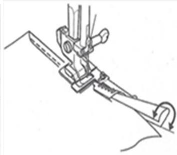
Mit dem Bandeinfasser lassen sich auf einfachste Weise fertige Schrägbänder falten und annähen. Die trichterförmige Führung formt das Band und legt es direkt um die Stoffkante. Mit einem Zier-, Zick-Zack- oder Geradstich nähen und schon ist die Kante versäubert.
